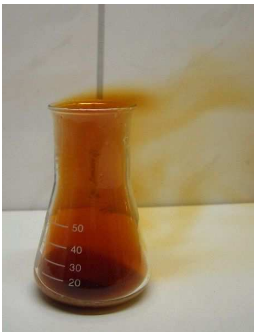
Obr. č. 11: Vznik oxidu dusičitého (reakce mědi a kyseliny dusičné) [12] dostupné z: http://commons.wikimedia.org/wiki/File:NO2.jpg
