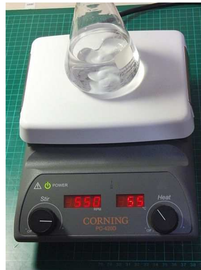
Obr. č. 12: Laboratorní magnetická míchačka s ohřevem [13] dostupné z: http://commons.wikimedia.org/wiki/File:Hot_plate_and_digital_stirrer.jpg
