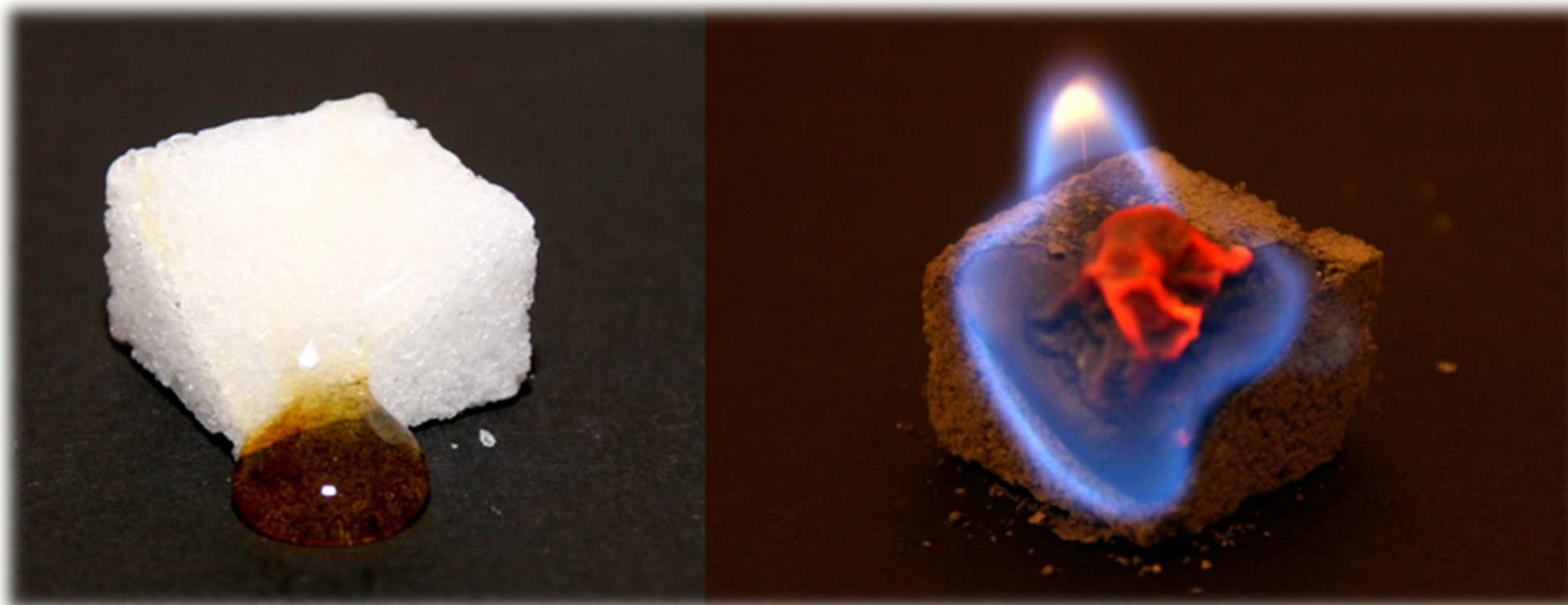
Obr. č. 5: Kostka cukru hoří pouze s katalyzátorem (popel) [6] dostupné z: http://commons.wikimedia.org/wiki/File:Verbrennung_eines_Zuckerw%C3%BCrfels_.png
