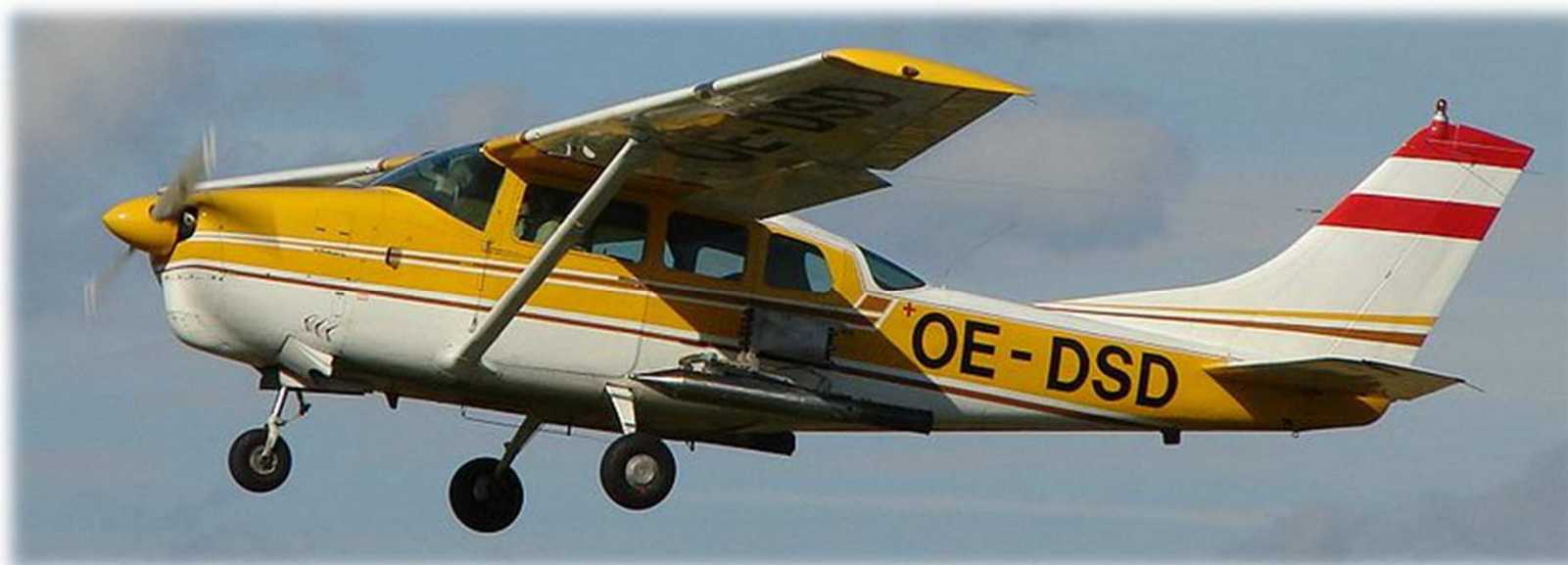
Obr. č. 7: Cessna s generátorem AgI [8] dostupné z: http://commons.wikimedia.org/wiki/File:Cessna_210_Hagelflieger.jpg
