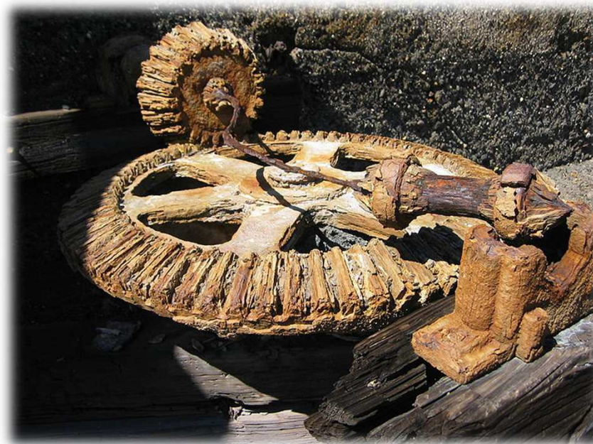
Obr. č. 4: Koroze [5] dostupné z: http://commons.wikimedia.org/wiki/File:Corroding_iron_machinery_at_old_White_Island_sulphur_mine_2.jpg
